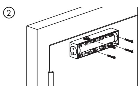
С помостью 4 винтов/саморезов закрепите на дверном полотне или коробке (в зависимости от выбранного варианта установки) корпус доводчика. Регулировочные петли должны быть со стороны петель.
