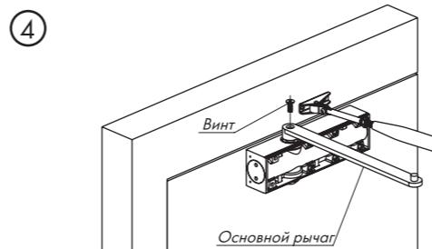
Закрепите на корпусе доводчика основной рычаг с помощью винта.
