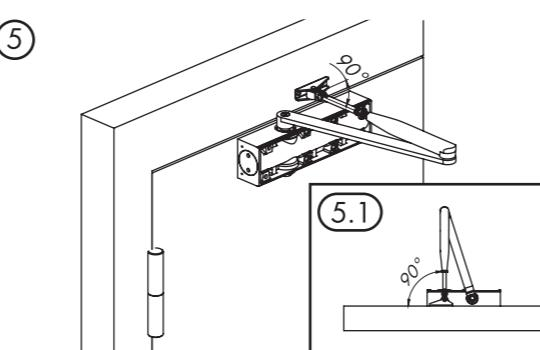
Выставьте длину регулируемого рычага, проворачивая винтовую часть по или против часовой стрелки.
